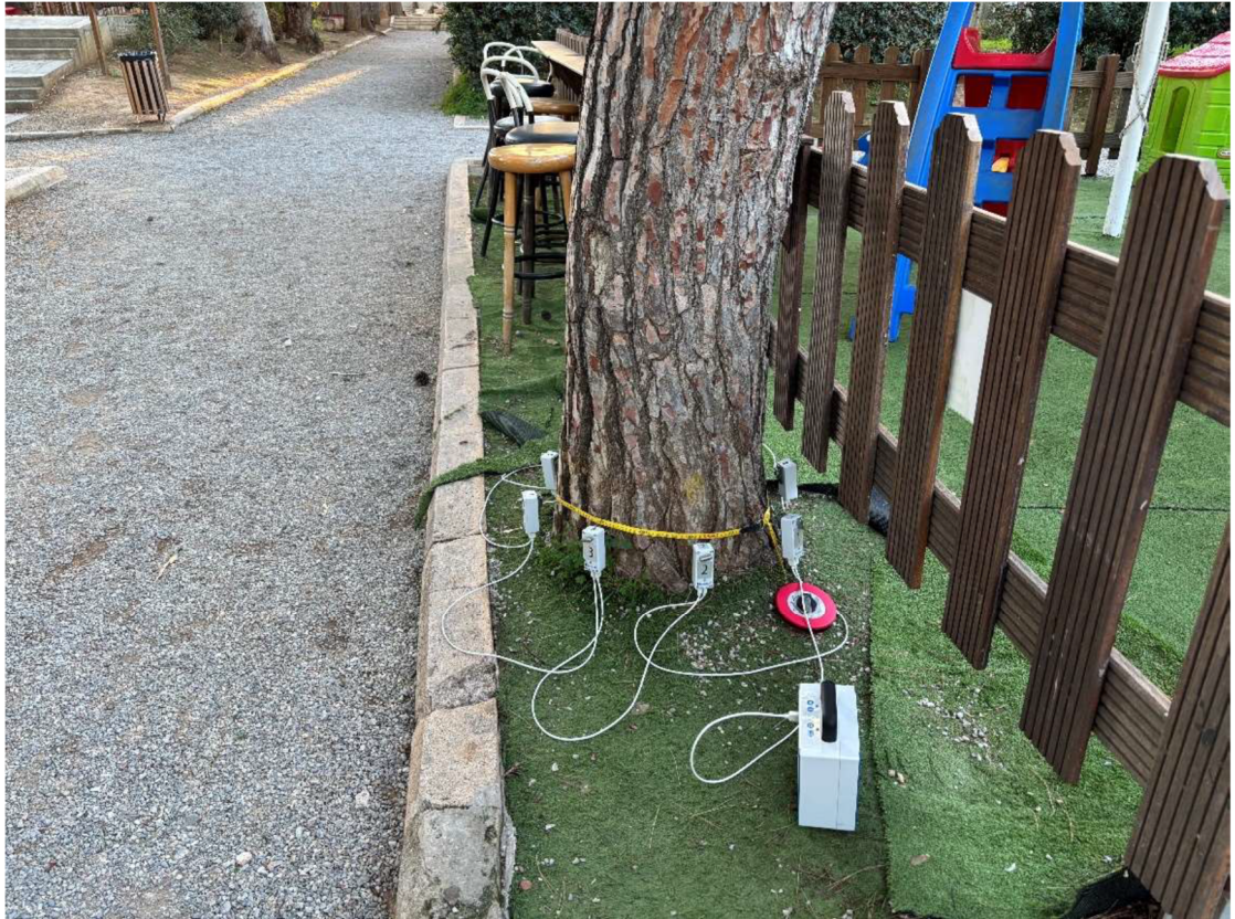
Εικόνα 3. Ηχητική Τομογραφία (Πηγή: Παρατηρητήριο Αστικού Πρασίνου Κρήτης)
