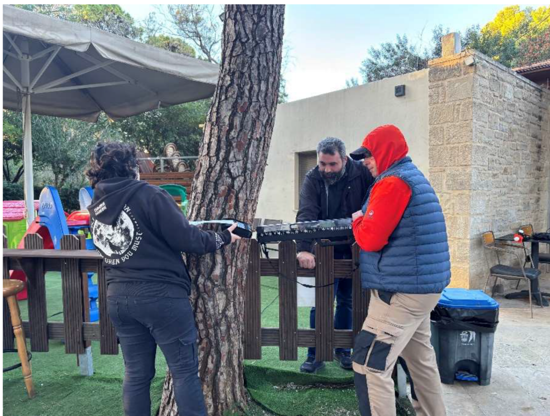
Εικόνα 4. Μέτρηση της αντίστασης στη διάτρηση (Πηγή: Παρατηρητήριο Αστικού Πρασίνου Κρήτης)
