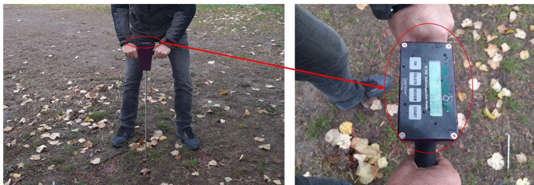
Εικόνα 5. Διειδυσήμετρο(penetrometer) με ηλεκτρονική εγγραφή της μεταβολής της αντίστασης στη διείδυση με το βάθος του εδάφους
