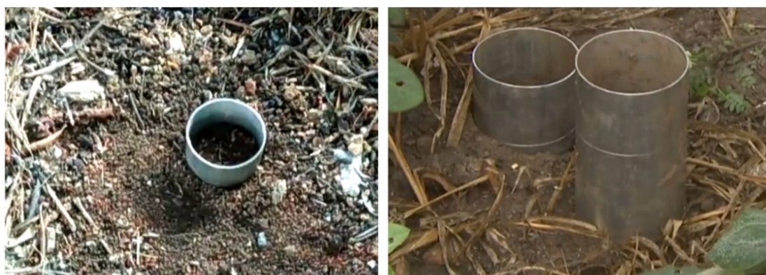
Εικόνα 6. Κύλινδροι λήψης αδιατάρακτου δείγματος εδάφους για την μέτρηση της φαινομενικής πυκνότητας
